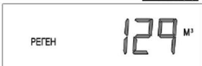
**Шаг 3Д** – Объем воды (в м<sup>3</sup>) после последней регенерации. Выводится объем воды (в м<sup>3</sup>), очищенной со времени последней регенерации. Если водосчетчик не установлен, на дисплее будет высвечиваться «0».
