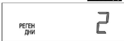
**Шаг 2Д** – Число дней после последней регенерации. Выводится число дней, прошедших со времени последней Регенерации.
