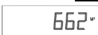
*Шаг 4А* – *Общее количество воды (в м³), использованное с начала работы.* На дисплей выводится значение общего количества воды (в галлонах), которое было использовано с момента начала работы клапана. На дисплее выводится «0» (ноль), если не установлен счетчик воды.
