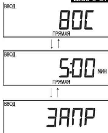
**Шаг 3'ОН** – Только в случае настройки систем Twin Alternating. Установите продолжительность (в минутах) дополнительной прямой промывки, которая будет проводиться перед выходом в Сервис фильтра, который находился в режиме ожидания. Кнопками «ВВЕРХ» или «ВНИЗ» установите требуемую продолжительность дополнительной прямой промывки (1-20 минут) или отключите ее («ЗАПР»).
