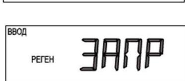
*Шаг 4ОН – Регенерация от внешнего сигнала.* Выберите способ проведения регенерации от внешнего сигнала после того, как на вход клапана, разъем обозначенный "DP SWITCH", будет непрерывно поступать внешний сигнал в течение 2-х минут.
