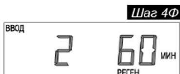
*Шаг 4Ф* – Введите продолжительность второго выбранного режима (в нашем примере – *регенерация «сверху вниз»*) при помощи кнопок «ВНИЗ» или «ВВЕРХ».
