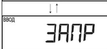
*Шаг 3'ОН – Только в случае настройки систем Twin Alternating.* Установите продолжительность (в минутах) дополнительной прямой промывки, которая будет проводиться перед выходом в Сервис фильтра, который находился в режиме ожидания. Кнопками «ВВЕРХ» или «ВНИЗ» установите требуемую продолжительность дополнительной прямой промывки (1-20 минут) или отключите ее («ЗАПР»).
