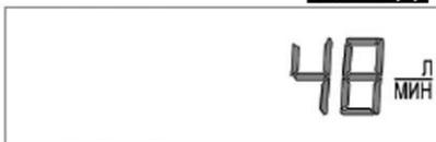
**Шаг 6Д** – Расход воды, максимальный за последние 7 дней. На дисплее появится значение максимального расхода воды (л/мин), который был зафиксирован за последние 7 дней. На дисплее выводится «0» (ноль), если не установлен счетчик воды.
